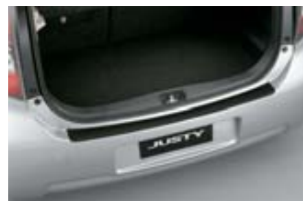
Protección metálica del dintel del maletero
